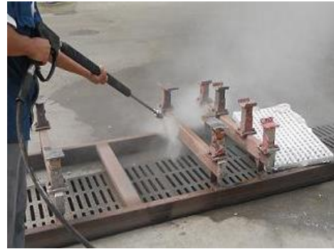
焊接后的焊渣清除
