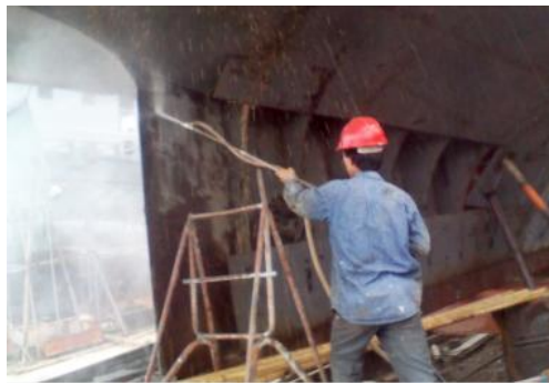
冲洗船体外侧及底侧海生物
